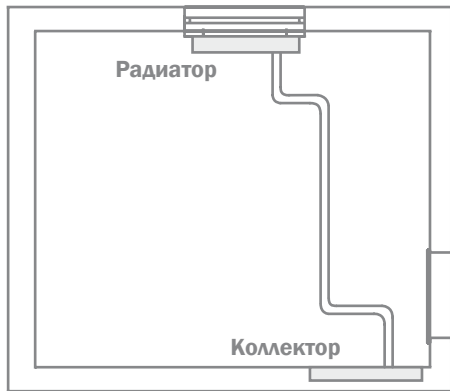
Пример прокладки трубы с учетом термического удлинения
