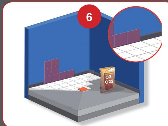
С использованием общепринятых клеевых растворов типа C2 или C2S положить плитку. На участках излома поверхности плитку следует резать по диагонали. Плитка на стене укладывается на края гидроизоляционной пленки.
