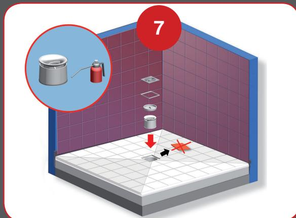
Снять защитную крышку с сифона и завершить сборку слива, устанавливая следующие элементы (см. рисунок): сифон, защитная сетка, квадратная рамка, решетка.
