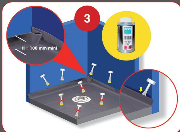
Выложить гидроизоляционную пленку на требуемой площади поддона; края пленки завернуть к стенке, приподняв на 3 - 4 см относительно планируемого уровня пола; заложить пленку в углы (как показано на рисунке); нанести клей по краям пленки и в углах.
