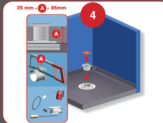
В зависимости от планируемой высоты стяжки отмерить высоту трубки решетки А, и при необходимости, укоротить. Для этого необходимо ее обрезать между выступами. Высота трубки А должна находиться в пределах от 25 до 85 мм. Затем перед последним выступом трубы решетки установить уплотнение (круглое кольцо). Установить решетку на сифон, а сверху - защитную крышку.
