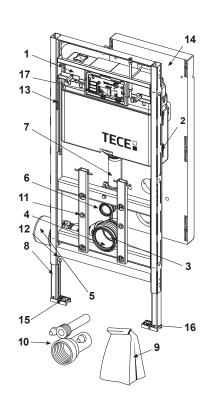
9600400 – TECElux застенный модуль TECElux 400 для установки подвесного унитаза, h=1120 мм, регулируемый по высоте, с системой очистки воздуха
