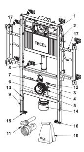
9310000 – TECEprofil застенный модуль для раковин, h = 1120 мм
