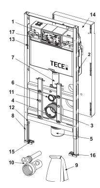
9600200 – TECElux застенный модуль TECElux 200 для установки подвесного унитаза, h=1120 мм, регулируемый по высоте
