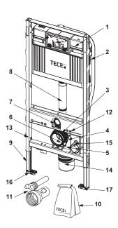
9300009 – застенный модуль TECEprofil для людей с ограниченной подвижностью со смывным бачком Uni, h = 1120 мм
