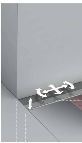
Размеры TECEdrainprofile можно подогнать к разным значениям толщины стенки и напольного покрытия.
