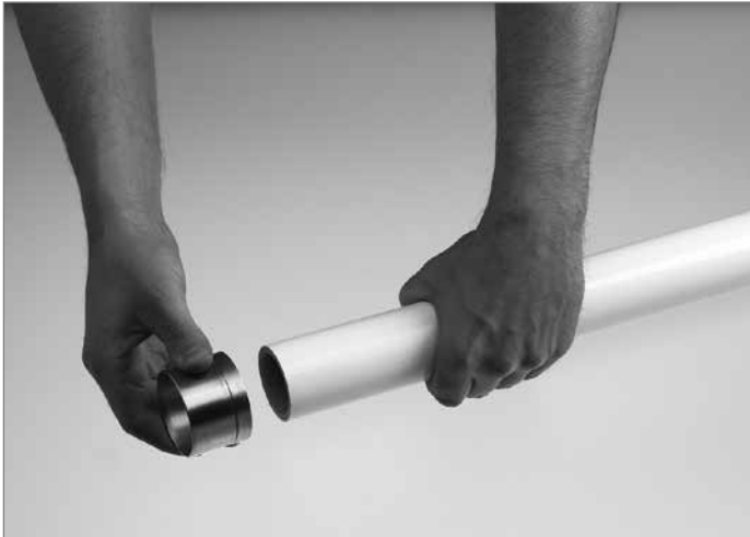
Пресс-штулка TECEflex насаживается на конец трубы. При этом гладкая сторона пресс-штулки (без внешнего кольца) должна быть направлена на фитинг
