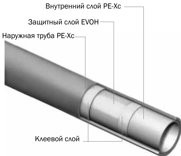
Структура трубы TECEflex-PE-Xc-5S
