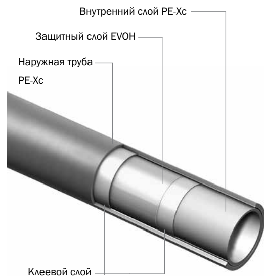
Структура трубы TECEflex PE-Xc 5S
