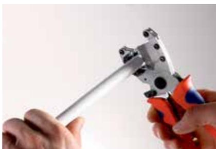
Обрезание трубы при помощи труборезных ножниц
