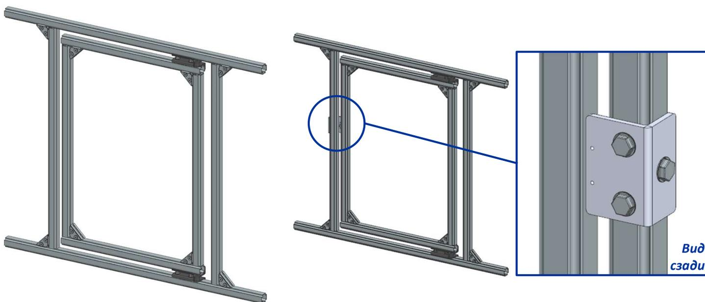
5. Подготовить два отрезка профиля для рамы ревизионного люка. Длина отрезков на 107мм меньше высоты проёма.
