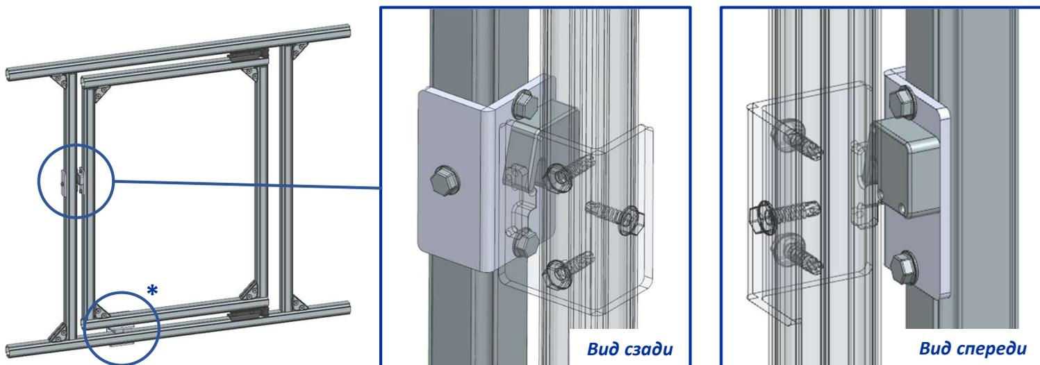
9. Установить уголок с защелкой на дверцу ревизионного люка на три самореза. Положение уголка определить по месту, исходя из корректности работы защелки. Для разметки рекомендуется использовать карандаш.
