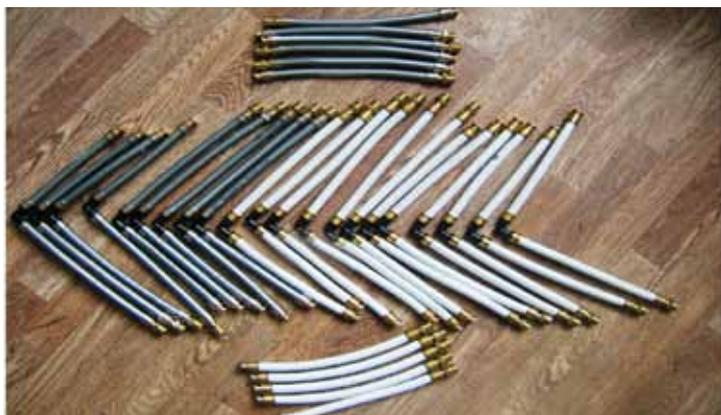
Рис. 10 - Соединения труб напорных TECeFlex с фитингами из PPSU и из латуни
