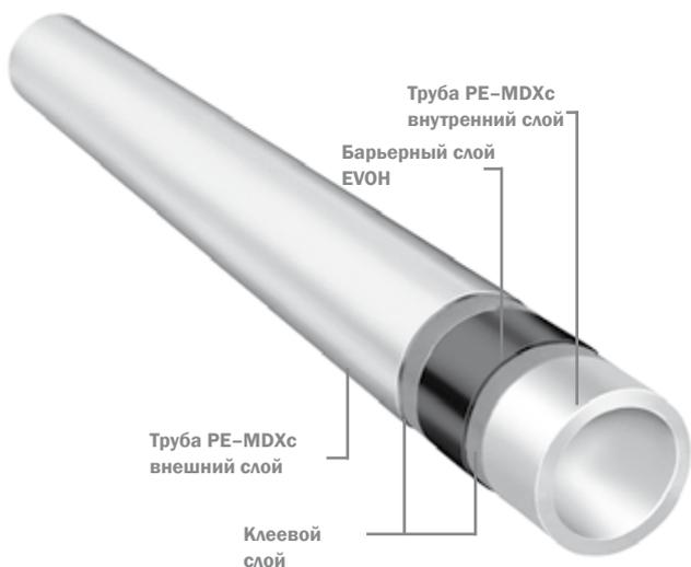
Рис. 5 - Схема слоёв трубы напорной многослойной для напольного отопления PE-MDXc
