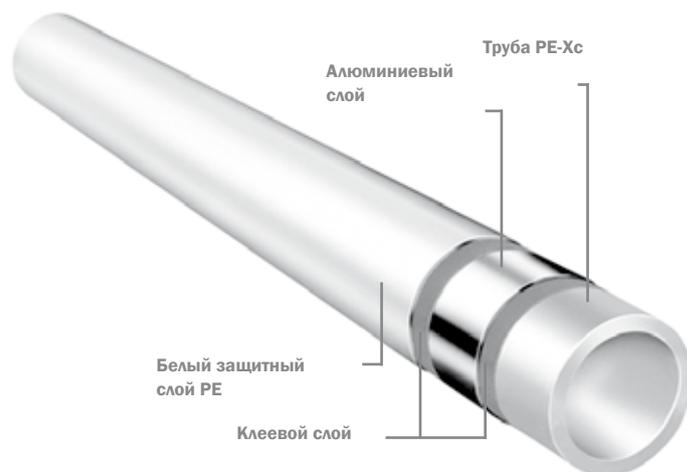
Рис. 1 - Схема слоёв трубы напорной металлополимерной PE-Xc/AL/PE TECEflex
