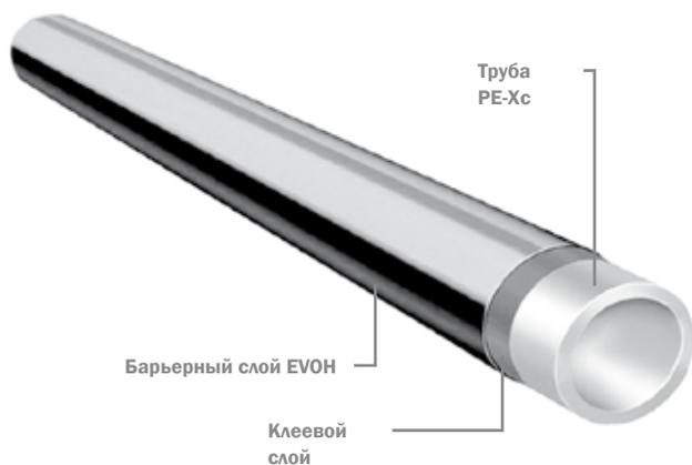
Рис. 4 - Схема слоёв трубы напорной многослойной из сшитого полиэтилена с наружным барьерным слоем PE-Xc/EVOH
