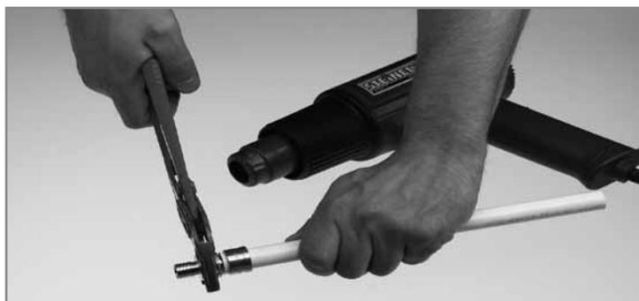
Рис. 20 - Демонтаж запрессованного металлического фитинга и трубы
