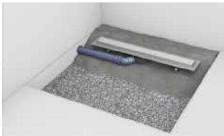
**Шаг 2:** Стяжка устанавливается с уклоном от 1 до 2% к каналу для обеспечения оптимального слива.
