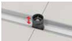
Погружной стакан с мембраной для сифонов TECEdrainline вместе с герметизирующей водой обеспечивает двойной сифонный эффект. Он минимизирует испарение герметизирующей воды через свою мембрану и блокирует неприятные запахи, что особенно подходит для редко используемых душевых.
