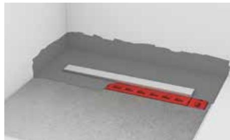
**Шаг 4:** После этого наносится первый слой композитного уплотнения.
