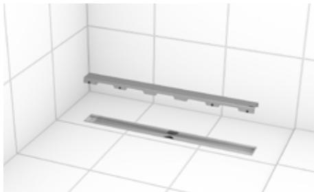
**Шаг 6:** После укладки плитки и затирки швов можно установить декоративную решетку в корпус канала.
