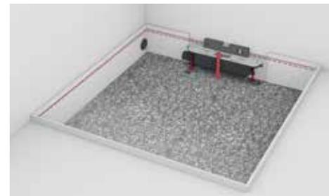
**Шаг 2:** Регулировка высоты слива значительно облегчается опционально доступными монтажными ножками.
