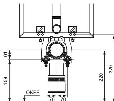
**Монтажный комплект TECEone для установки с настенными модулями сухого монтажа со смывным бачком Osta**
