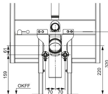
**Монтажный комплект TECEone для для установки с настенными модулями сухого монтажа Geberit Duofix\***
