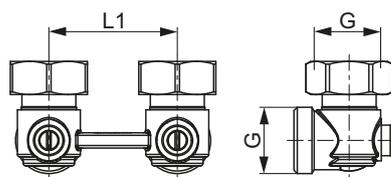
Запорно-присоединительный узел TECE для нижнего подключения радиаторов 1/2" МТ, проходной
