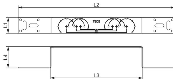
Усиленная монтажная пластина TECE из оцинкованной стали для трех настенных уголков
