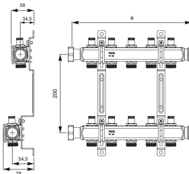
**Коллектор TECE из нержавеющей стали для систем отопления без индикатора потока и без запорных вентилей**
