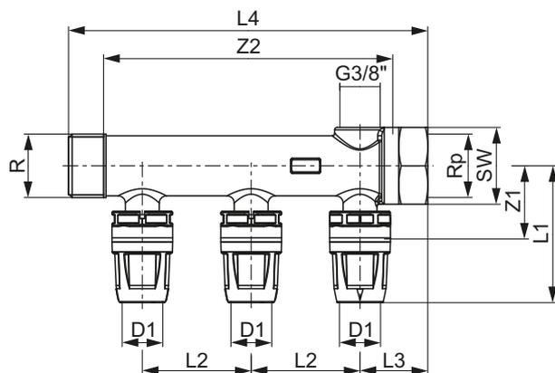
Коллектор TECElogo-Push, DR-латунь, плоское уплотнение, с накладной гайкой
