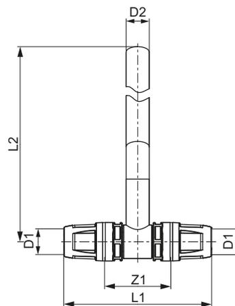
Монтажный узел TECElogo-Push для подключения радиатора
