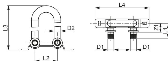
Монтажный узел TECEflex для подключения радиаторов, настенный, никелированный
