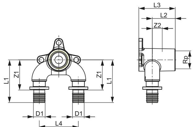
Тройник угловой редуцирующий с настенным креплением TECEflex, закругленный, с низким падением давления, кремнистая бронза
