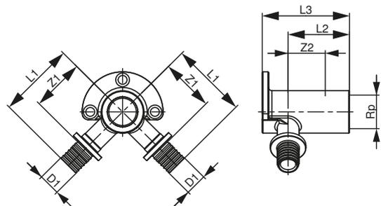
Тройник угловой с настенным креплением TECEflex, закругленный, с низким падением давления, кремнистая бронза
