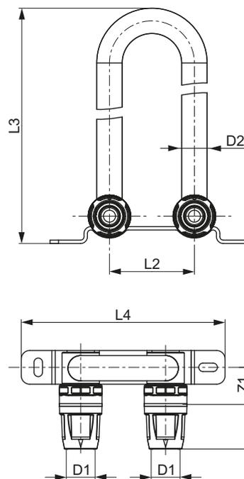
Монтажный узел TECElogo-Push для подключения радиаторов
