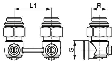
Монтажный набор TECEflex для подключения радиаторов к плитусной разводке
