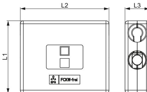
Запорно-присоединительный узел TECE для нижнего подключения радиаторов, проходной
