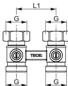
Запорно-присоединительный узел TECE для нижнего подключения радиаторов, угловой
