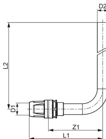
Монтажная трубка TECElogo-Push для подключения радиатора проходная
