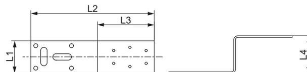
Монтажная пластина TECE из оцинкованной стали для двух настенных уголков
