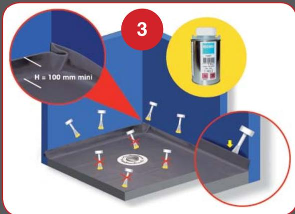
Выложить гидроизоляционную пленку на требуемой площади поддона; края пленки завернуть к стенке, приподняв на 3 - 4 см относительно планируемого уровня пола; заложить пленку в углах (как показано на рисунке); нанести клей по краям пленки и в углах.
